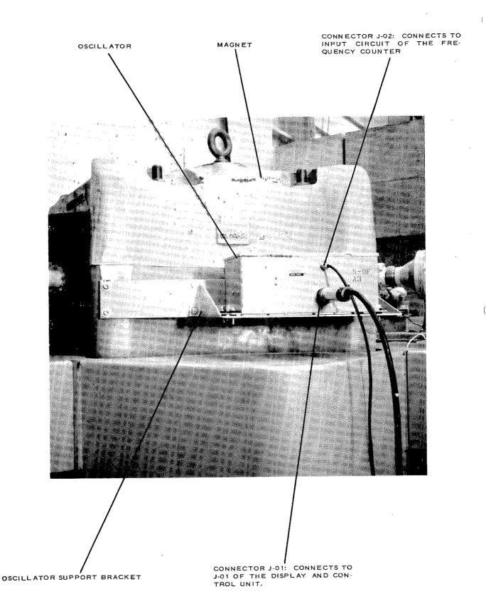
FIGURE 3. TYPICAL INSTALLATION - NMR OSCILLATOR
